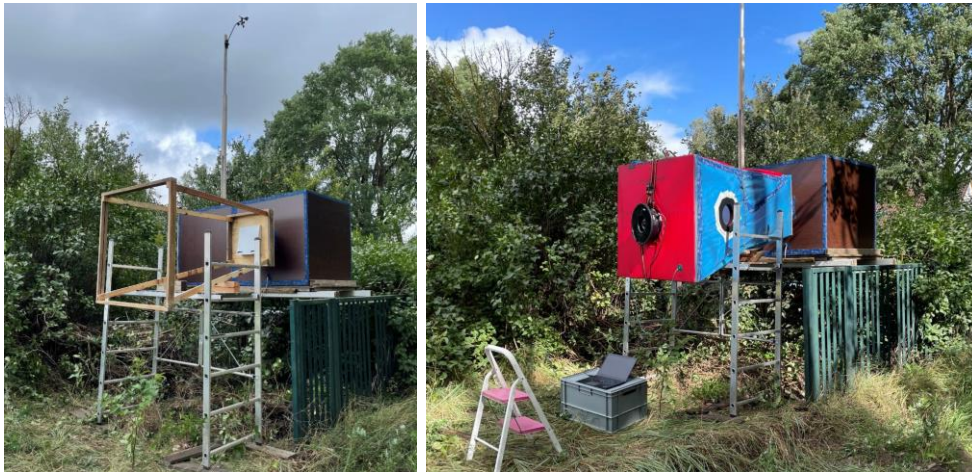
Abbildung 13: Messaufbau mit Ventilator zur Simulation eines steten Winddrucks
