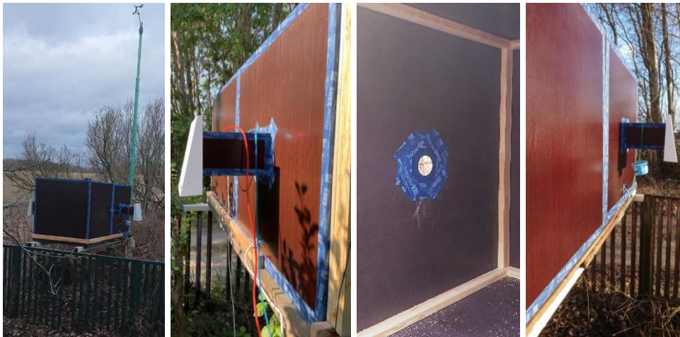
Abbildung 3: Messaufbau der paarweise arbeitenden Lüftungsgeräte
